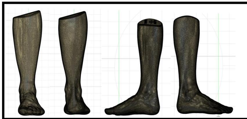
**Figura 1.** Modelo virtual de pierna, tobillo y pie, a partir de datos antropométricos de Latinoamérica para la generación de la AFO.
