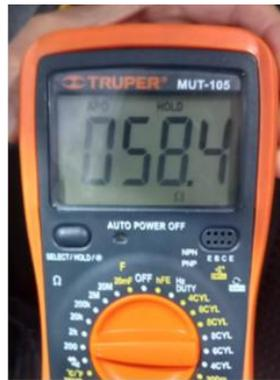
**Figura 9.** Resistencia entre Can High y Low.
