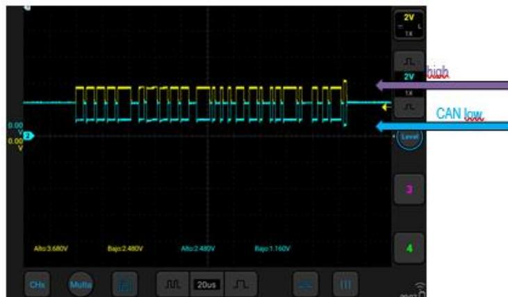
**Figura 3.** Señal CAN del vehículo.
