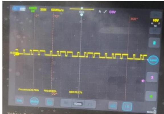
**Figura 6.** Señal Sensor CMP.
