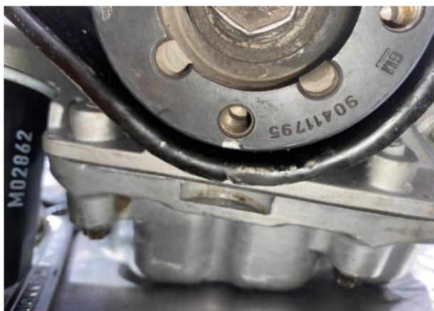
**Figura 2.** Polea del cigüeñal.
