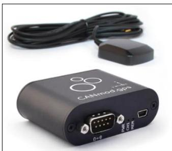
**Figura 1.** Módulo CANmod.gps.
