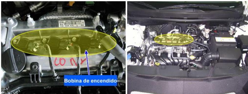
**Figura 10.** Ubicación y ejemplificación de bobinas de encendido en un vehículo.
