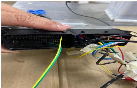
**Figura 4.** Pines conectados para el banqueo.
